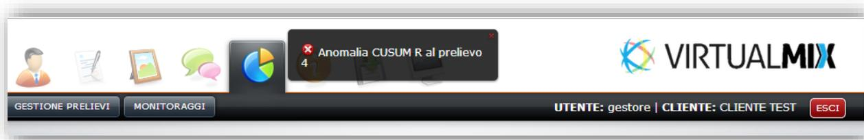
Il sistema rileva l'anomalia indicando anche il momento in cui si è presentata. Nella parte bassa dello schermo comparirà la finestra di correzione nella quale sarà automaticamente determinata la contromisura da adottare per risolvere l'anomalia.
